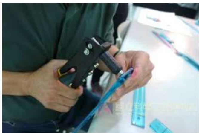
九、將拉釘短邊套入#1 孔中，用拉釘槍套入拉釘長邊後反覆壓緊，拉釘會自動斷掉，即完成製作。
