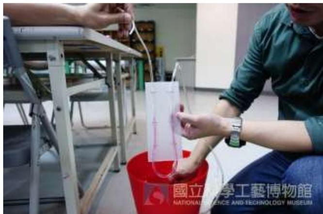
十、閉口型水壓計測試：將水壓計的開口端以長尾夾夾緊，或是用手捏緊，此時可以測試高壓下的液面變化。
