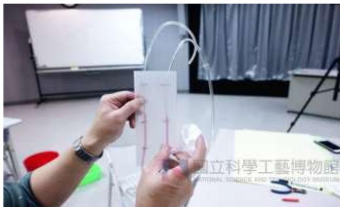
八、剪取一段輸液管，一端連結水壓計，另一端連結漏斗，即可進行測試。
