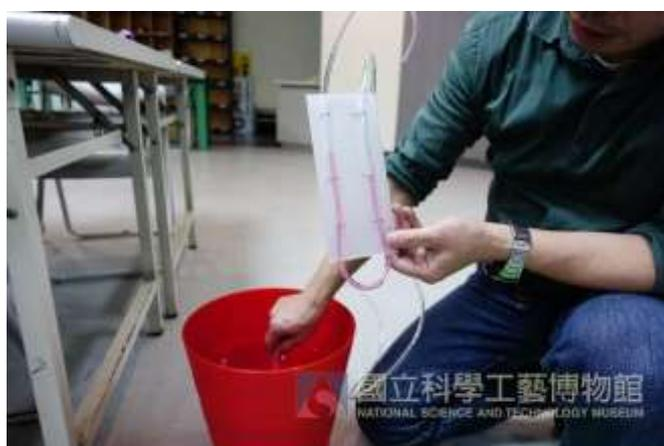
九、開口型水壓計測試：將漏斗沒入水中，其深度與水壓計水柱高低預期將呈現線性變化。
