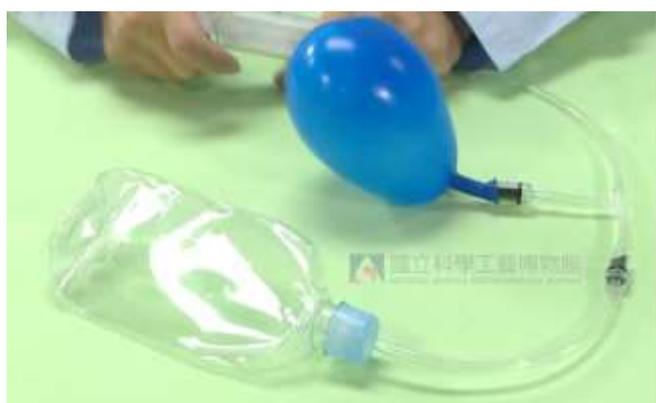
四、單向閥出氣端連接小氣球測試出氣效果，單向閥入氣端連接寶特瓶測試吸氣效果。
