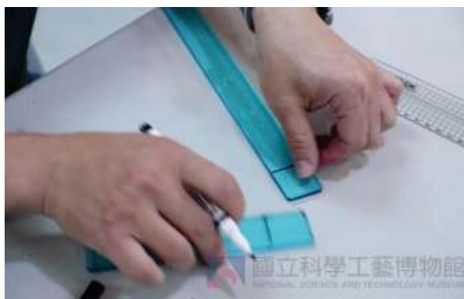
三、取其中一段排尺，依序在每段排尺的兩端畫出排尺寬度的正方形。
