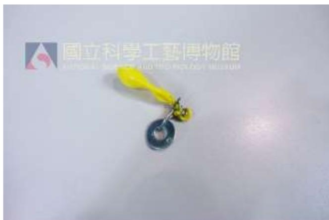
三、先在氣球內灌入一些氣體再打結，打結處用錫線綁一個墊片，放入水中測試，修剪錫線長度使氣球在實驗開始時能剛好減頂。
